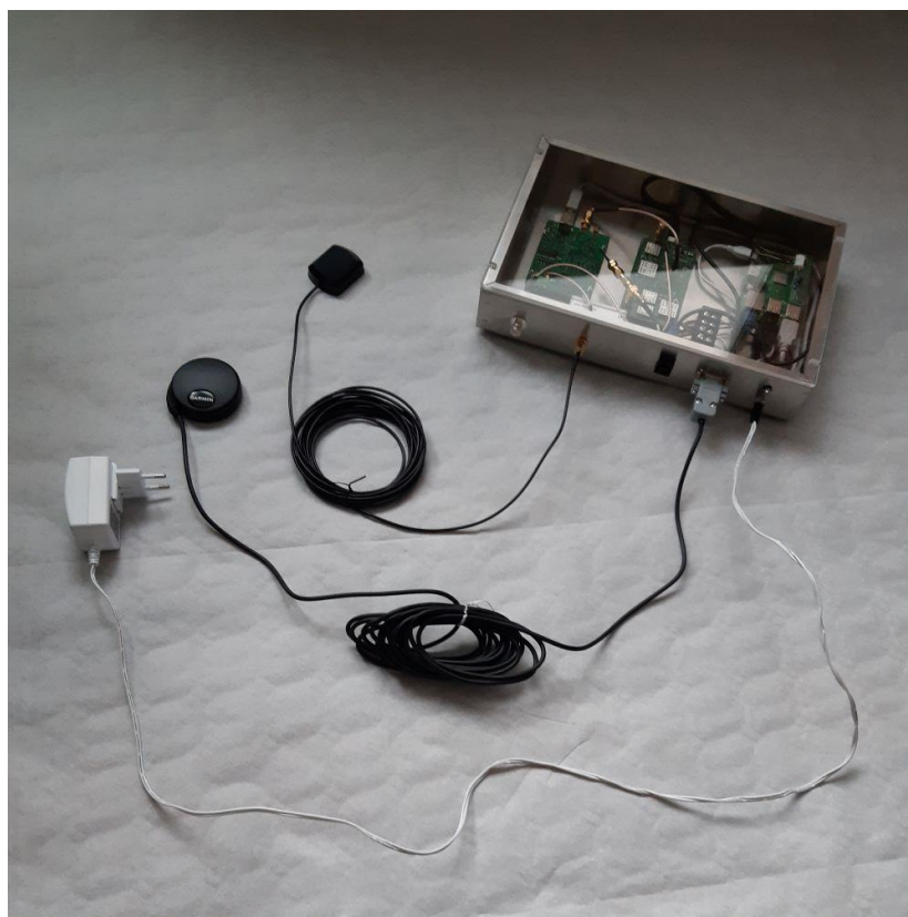
Figure 9 : Connexion vers le boîtier de réception. A gauche sur le boîtier se trouve le connecteur BNC vers lequel il faut connecter le câble coaxial. Au milieu se trouve un connecteur Ethernet qui n'est pas a priori utilisé dans le cadre de l'application MOMSTER.
