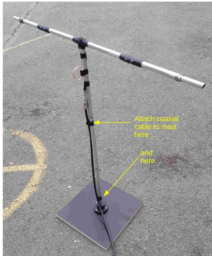
Figure 10 : Attachez le câble au mât avec le ruban de PVC pour diminuer la tension sur le connecteur. Notez qu'il s'agit d'une ancienne version de l'antenne sur cette photo mais le principe reste identique.
