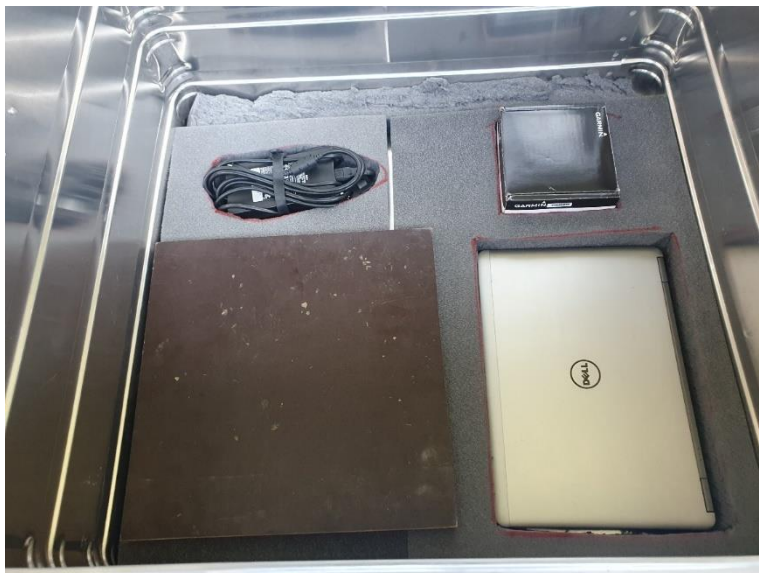
Figure 4 : couche de mousse dans la boîte métallique Zarges avec des emplacements prévus pour l'alimentation du PC (en haut à gauche), la base (en bas à gauche), la boîte en carton avec les 2 GPS et le boîtier d'alimentation du boîtier de réception (en haut à droite) et le PC (en bas à droite). Notez que la disposition n'est pas exactement identique dans chaque boîte Zarges.
