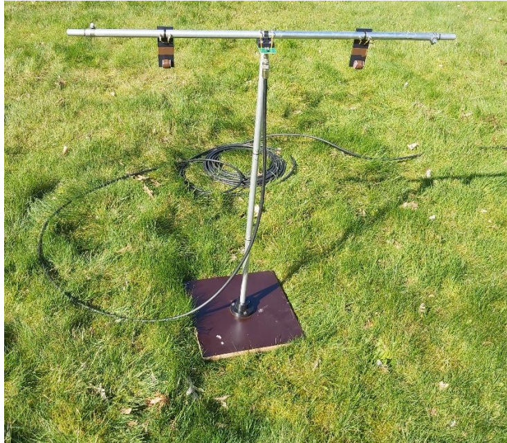
Figure 5: Antenne dipolaire, mât, câble et base en contreplaqué.
